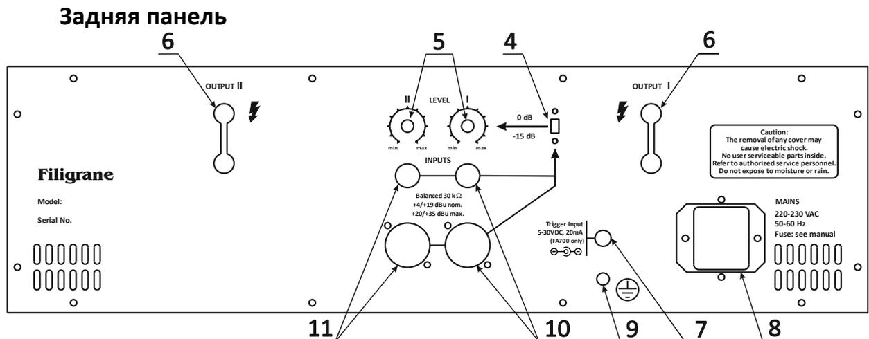
4. Выключатель аттенюатора входного сигнала.
