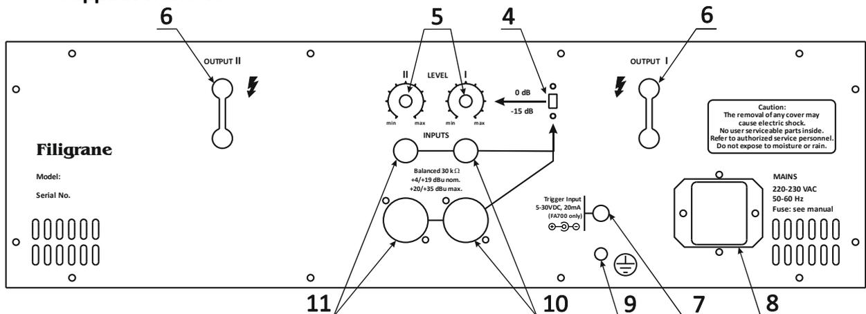
4. Выключатель аттенюатора входного сигнала.
